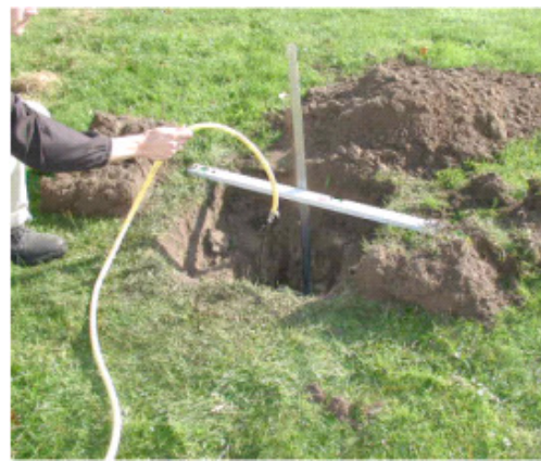
Vandmætning af jorden kan begynde. Der fyldes min. 0,20 m vand over gruslaget.
